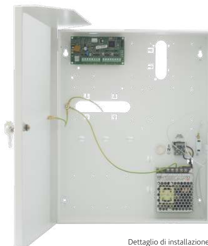
Dettaglio di installazione su cabinet metallico
